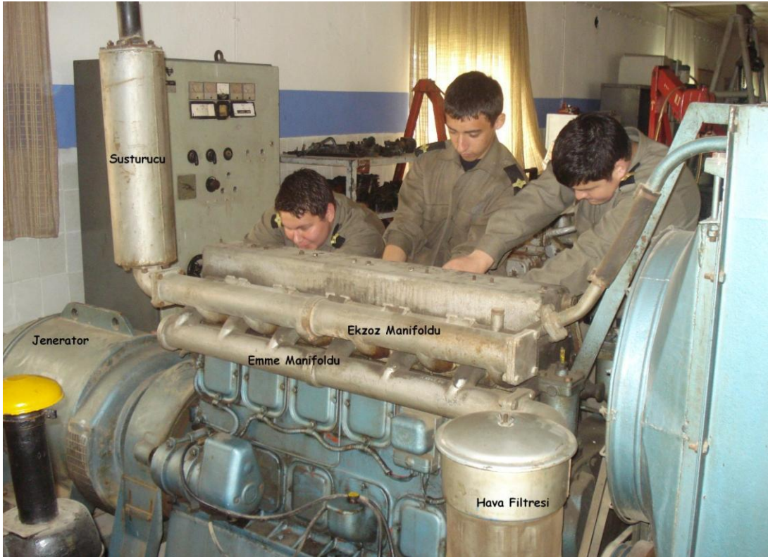
Őekil 3-16 : Egzost ve emme manifoldlarının makine üzerindeki yerleri
