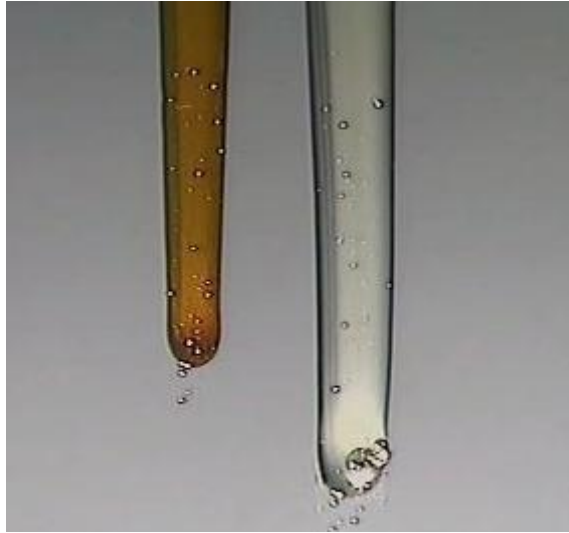
Şekil 3-45 : Yağlama yağının sürtünen yüzeyler üzerinde viskozitesine göre farklı akışı
