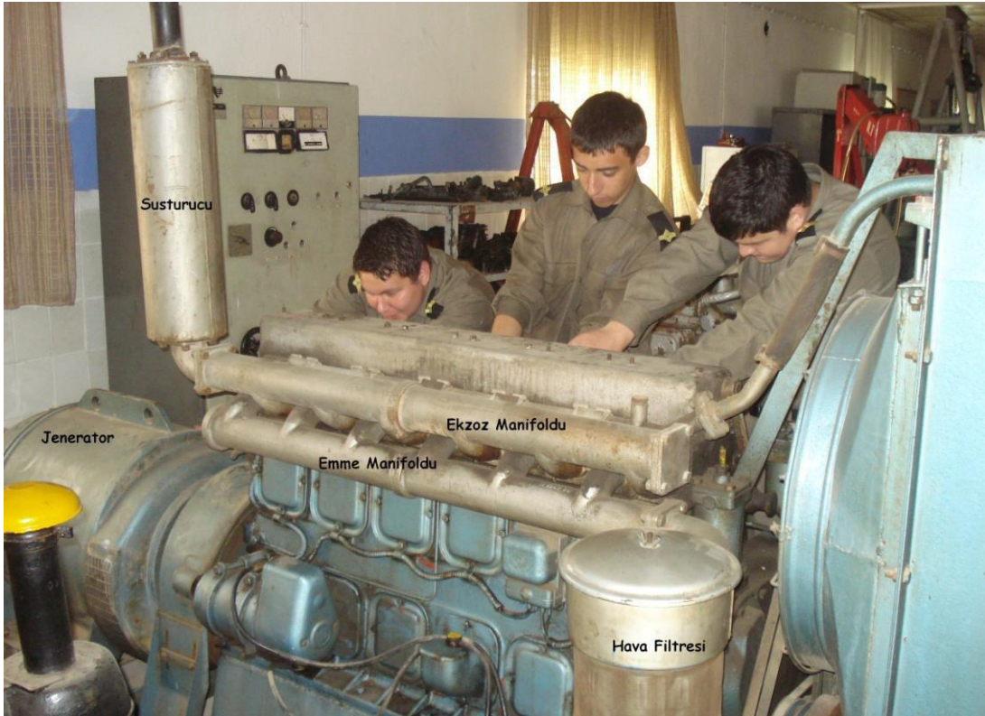
Şekil 3-16 : Egzoz ve emme manifoldlarının makine üzerindeki yerleri
