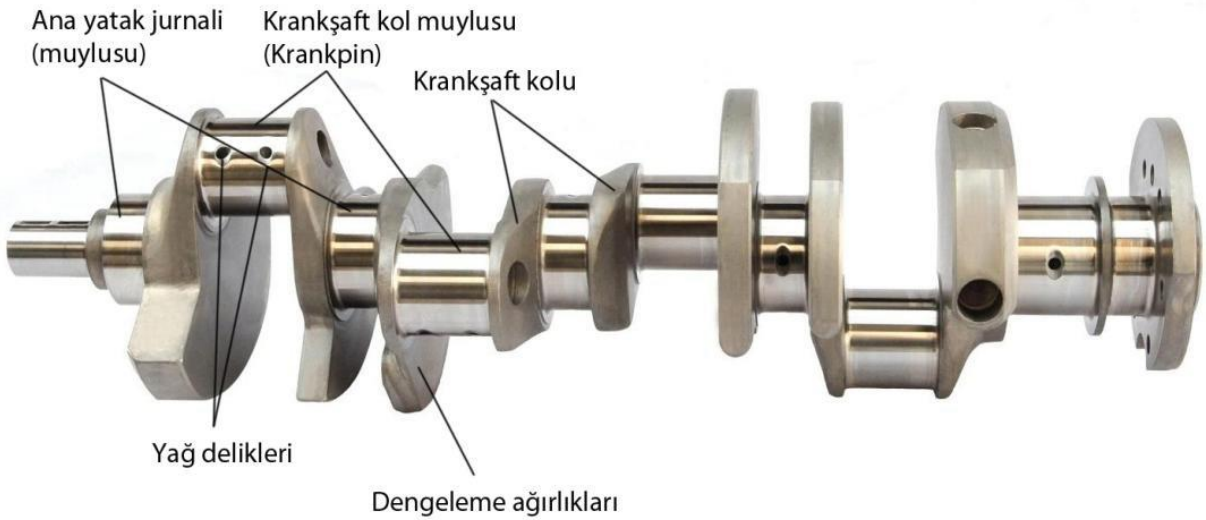
Şekil 3-24 : Krank şaft ve parçaları
